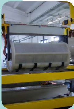
Figura 4: Linee di zinco acido da 4.000 kg/h
